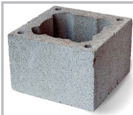
Mantelplokk 140/160 MULTI. Mõõdud 360x360x240 mm, 4 tk/m
